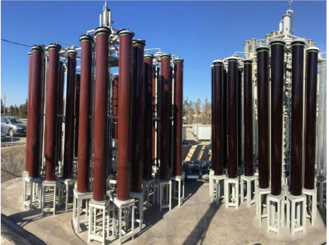
Eksempel på bio-reaktor for produksjon av alger til fiskefor. Sementfabrikken i Kjøpsvik slipper ut store mengder CO2 som vil være råstoff.
