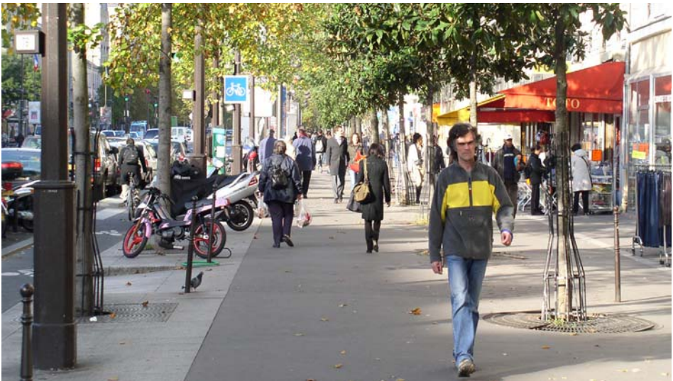
De brede fortauene på Straume skal ha plass til trerekker. Kanter og renner er av granitt og gangbanen er støpeasfalt. Avenue d'Italie, Paris. Foto: RS
