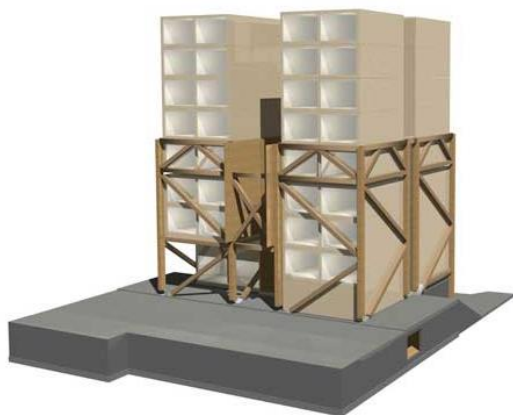
Figur 1-4 Modulkonstruksjon. Kilde: SWECO (2014)
